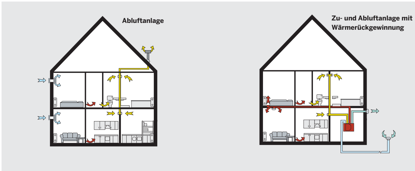
Systemvarianten der kontrollierten Wohnungslüftung
